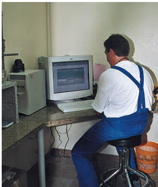
▲ Philippe Girard pilote l'Egar 250-4 d'un local spécifiquement aménagé. Il reçoit les programmes des pièces à usiner sur disquettes que son frère Pascal a préalablement préparé sur un autre ordinateur avec un logiciel de dessin.
